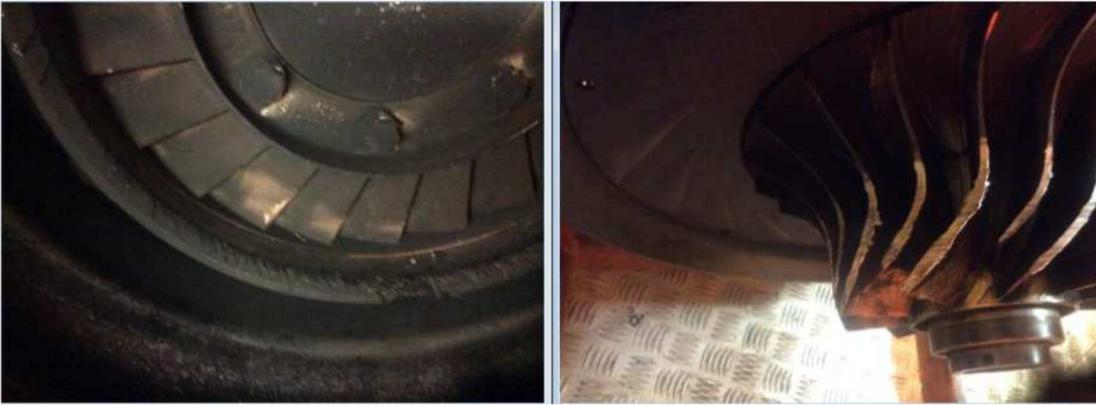
Figura 31: Componentes danificados da turbina
