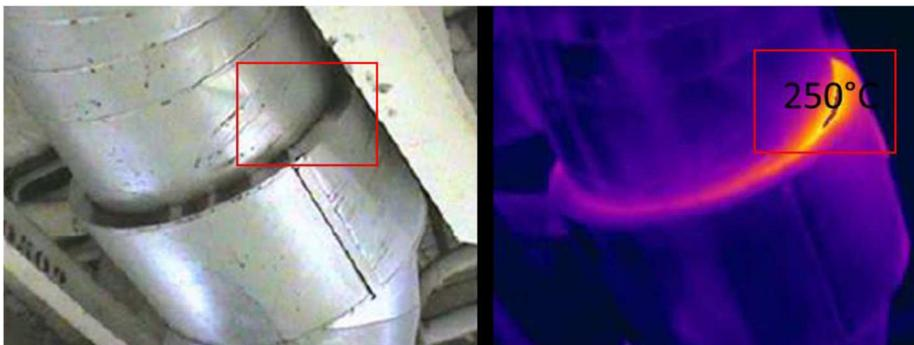
Figura 21: Exemplo de inspeção termográfica que não atende ao requisito SOLAS, com temperatura acima de 220°C em flange da linha de exaustão, com ponto quente na interface de transição entre isolamento térmico.
