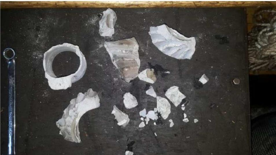
Figura 32: Pedacos desintegrados do impedidor retirados na admissão de ar do turbocharger.
