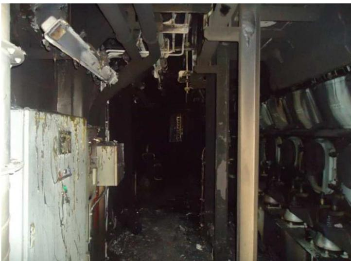
Figura 3: Sala de máquinas após incêndio devido a vazamento de combustível.
