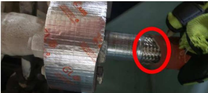
Figura 17: Verificação de integridade das proteções de mangueiras.
