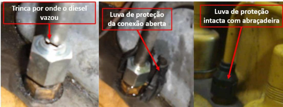
Figura 11: Luva de proteção em conexão de tubulação de óleo diesel instalada incorretamente gerando incêndio após quebra de conexão.
