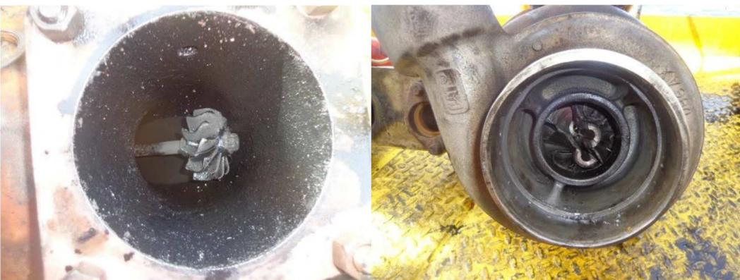
Figura 33: Eixo onde originou a falha do turbocompressor defeituoso.
